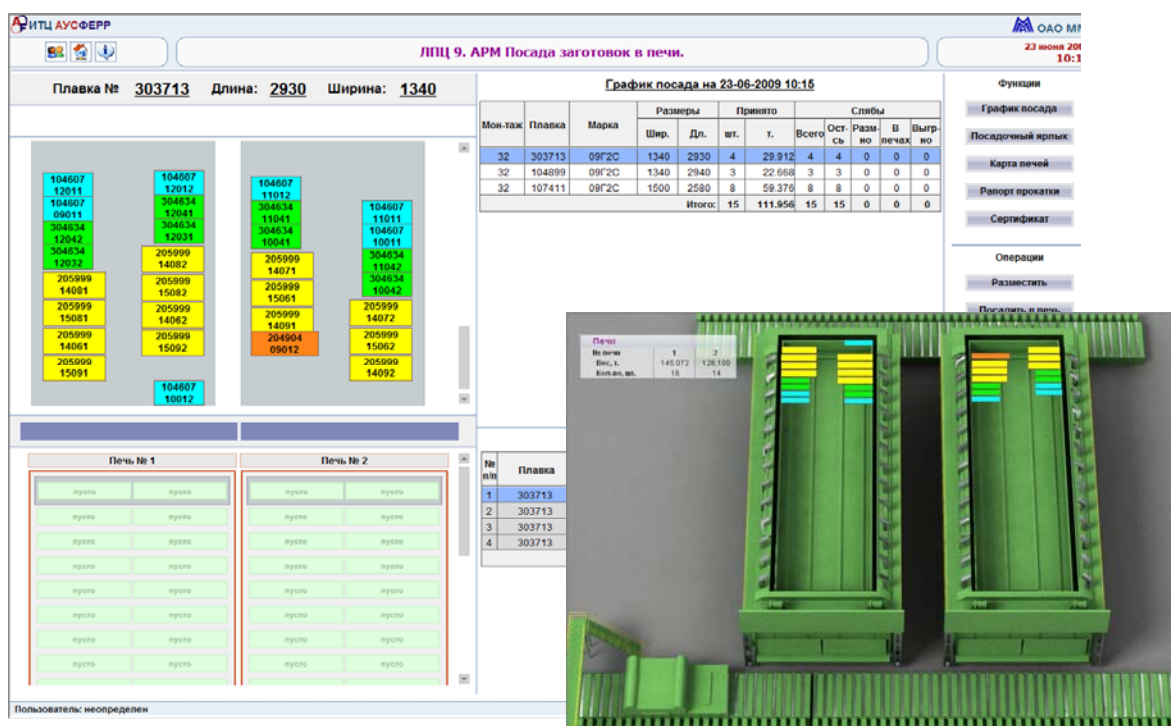
Рис.4. Окна АРМ посадки слябов в нагревательную печь.
